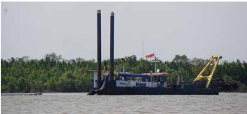
Gambar 7.8 Kapal keruk untuk menyedot endapan sedimen yang menyebabkan pendangkalan Laguna Sagaraanakan. (Foto: Oki Oktariadi).
